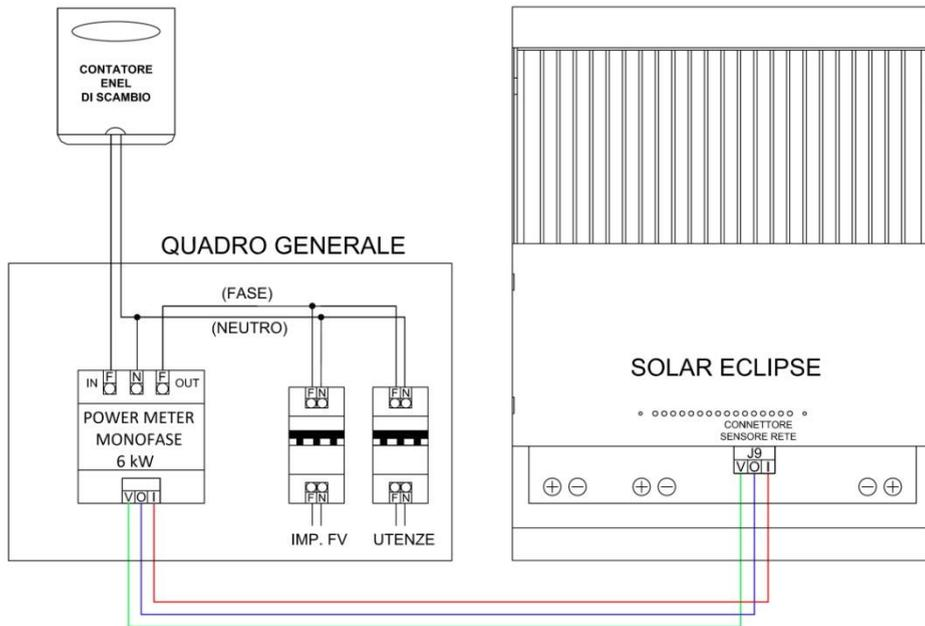
Figura 9 – Cablaggio sensore di rete (POWER METER)
