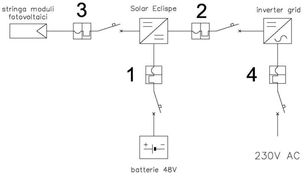
Figura 14 - Schema ordine chiusura/apertura sezionatori avvio/arresto
