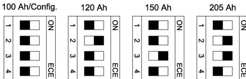
Figura 11 – Configurazione batterie tramite *dip-switch*
