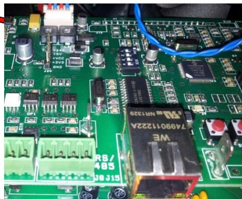
Figura 10 – Dip-Switch di configurazione
