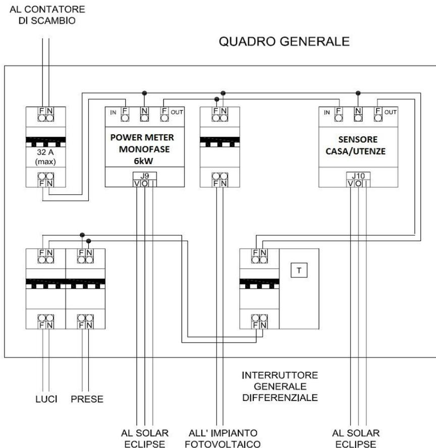
Figura 8 – Schema cablaggio quadro elettrico
